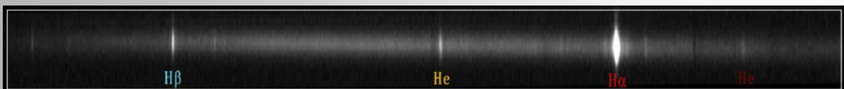
Abb. 2: Niedrigdispersives Spektrum der Nova aufgenommen vom Autor am 2021-04-01 mit einem DADOS-Spektrographen; Gitter 300 L/mm; 0,36m SCT, Summenspektrum 16x300s (vertikal gestreckt), CCD-Kamera STF-8300M;
