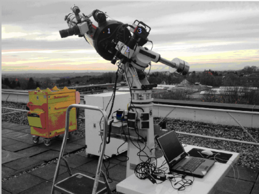
Abb. 4: Der Aufbau mit dem C11-Teleskop, dem DADOS-Spektrographen und der Kamera (STF 8300)
